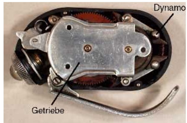
Bild 2: Inneres einer Dynamo-Taschenlampe, Hersteller IKA (DDR), 50er Jahre.
