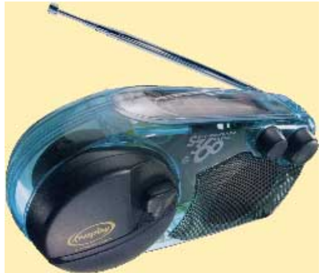
Bild 18: Auch beim S 360 werden Aussehen und Gewicht vom Federwerk beherrscht [26].
